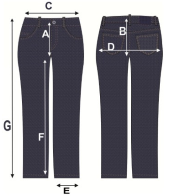
Figura 4 - desenho técnico e tabela de medidas: dimensões do produto em centímetros
