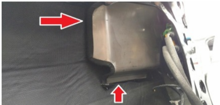
OBSERVAÇÃO: Detalhe do reforço em chapa de aço inox na região da maçaneta
