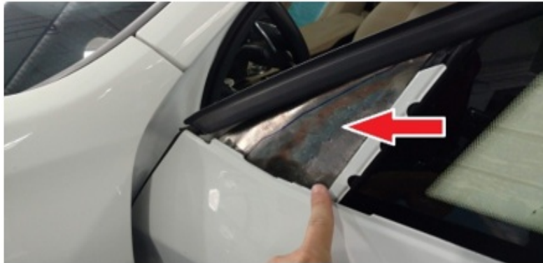
OBSERVAÇÃO: Chapa de aço inox aplicada na região do retrovisor externo
