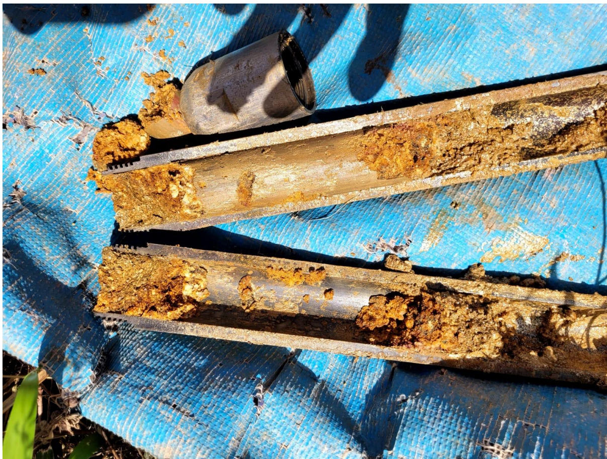
Figura 4 - Execução da Sondagem SPT.
