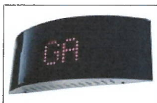
Figura 07: Painel de pavimento acima das portas
