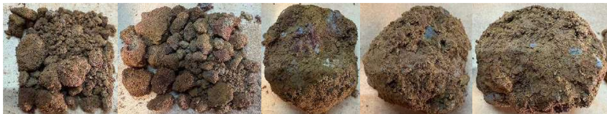
Detalhe do silte argilo arenoso (residual)
