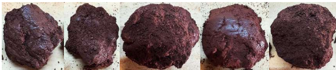
Detalhe da argila silto arenosa
