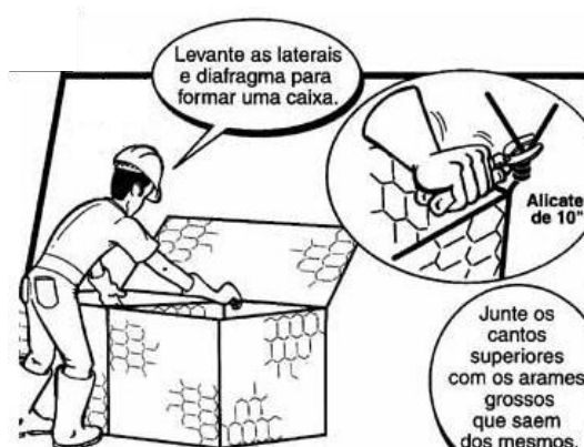
Figura 11. Posicionamento dos painéis laterais e diafragmas.
