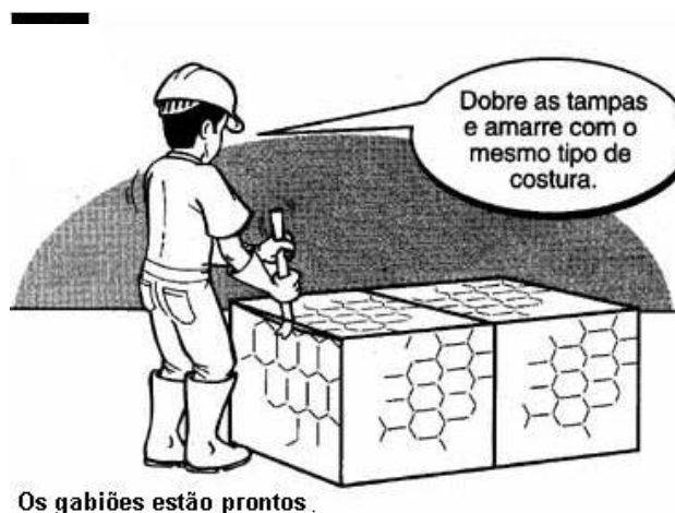
Figura 18. Detalhe da etapa de fechamento do gabião tipo caixa.
