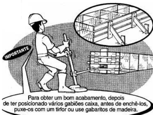
Figura 14. Detalhe da utilização do tirfor ou gabarito.
