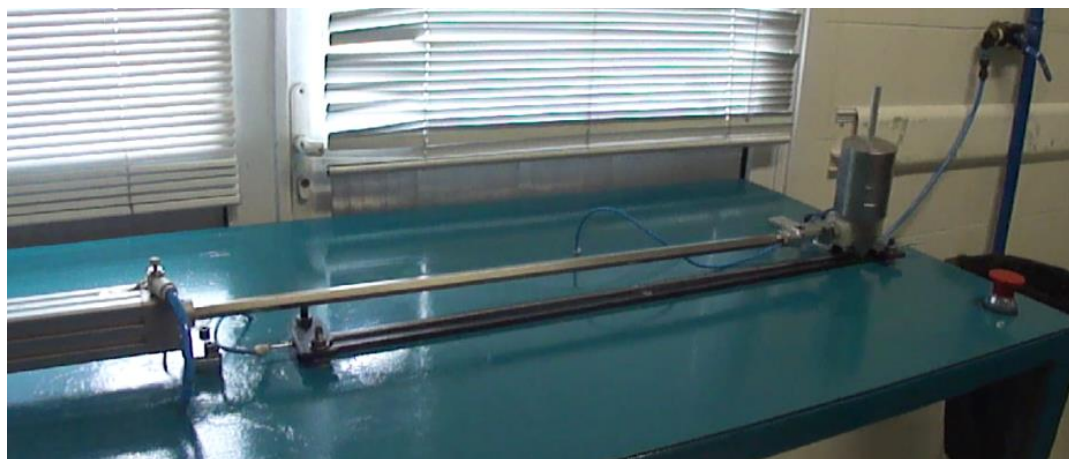
Figura 3. Ensaio de abrasão, adaptado da norma NBR 7577
