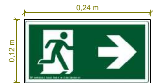
PLACA DE SENTIDO DE SAÍDA
