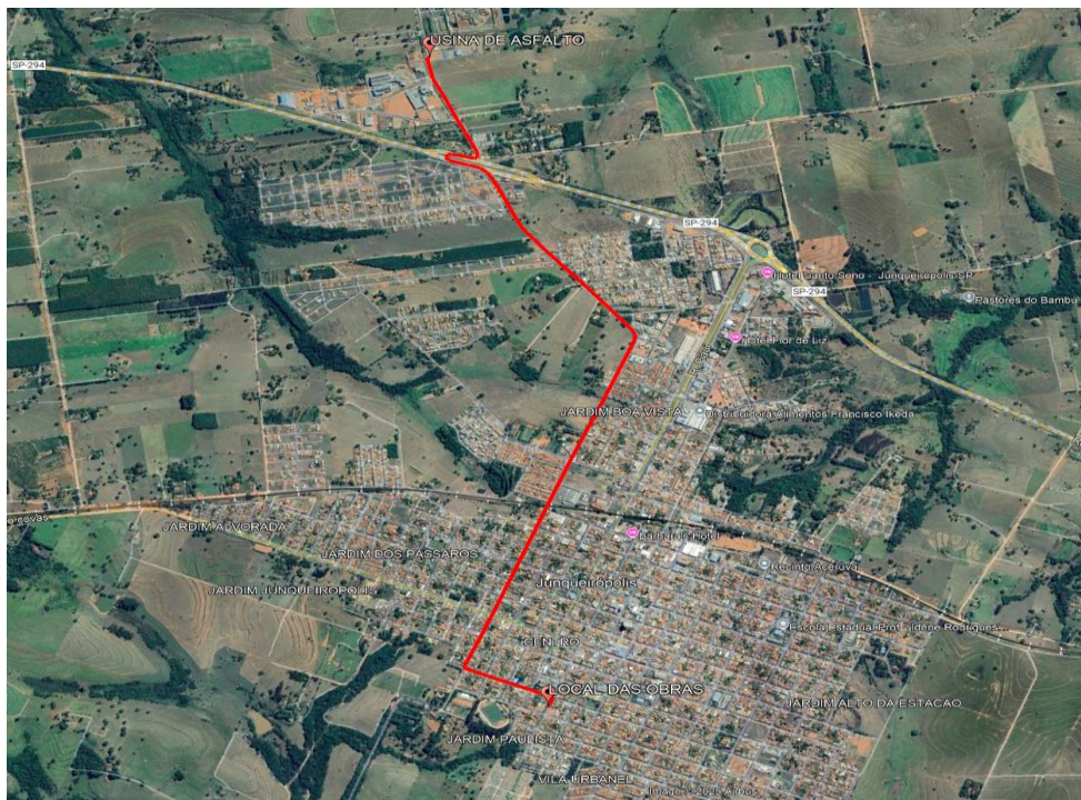
Figura 01: Distância de transporte da usina de asfalto até o ponto médio das frentes de obra e vice-versa – DMT = 4,672 Km
