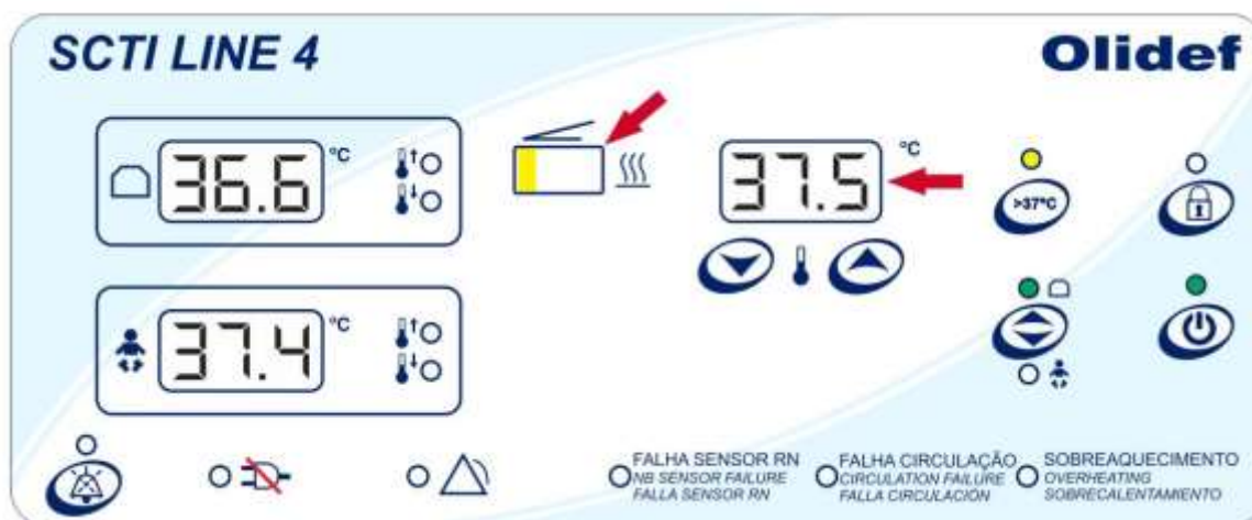
Figura 101 – Set point da temperatura do AR acima de 37°C
