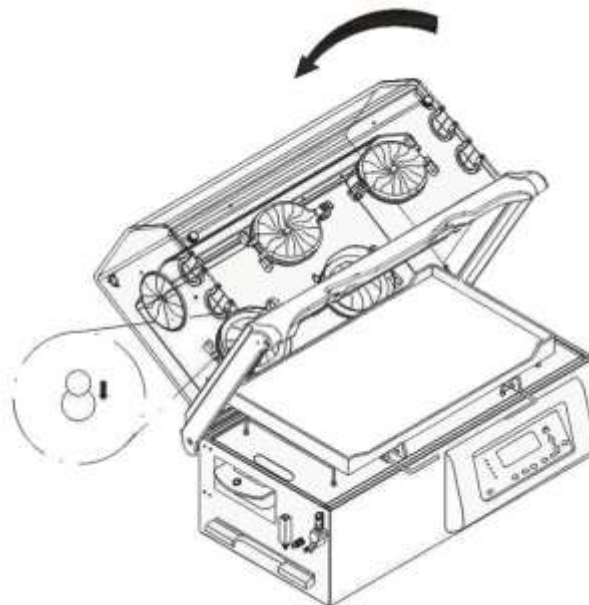
Figura 204 - Retirando cúpula interna
