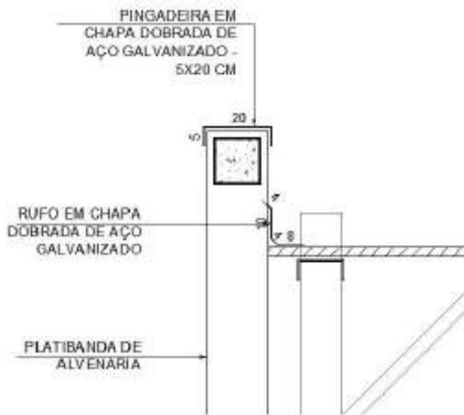
Figura 8 – imagem exemplificativa de detalhe de rufo/alvenaria e pingadeira
