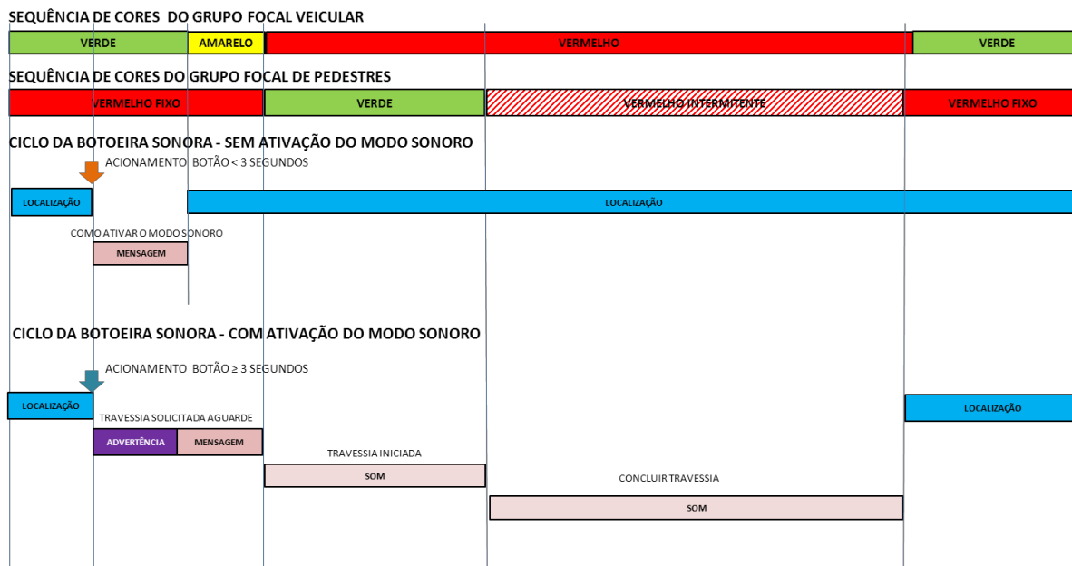
Figura 12: Ciclo de funcionamento da botoeira sonora
