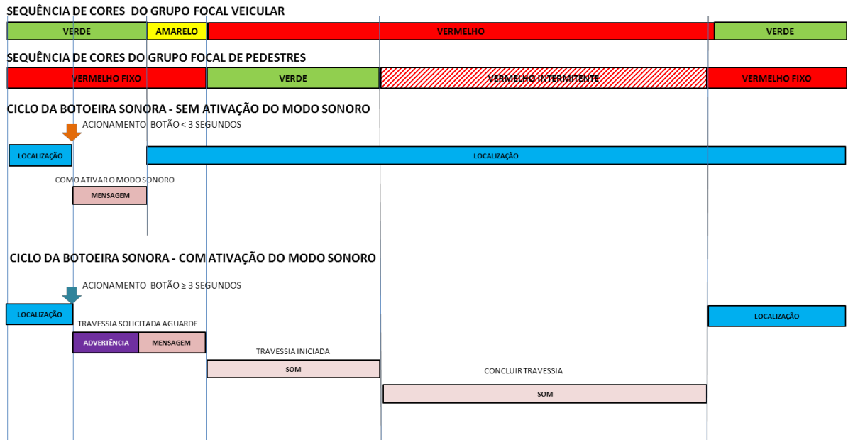
Figura 12: Ciclo de funcionamento da botoeira sonora
