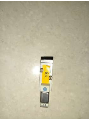
Válvula solenóide danificada
