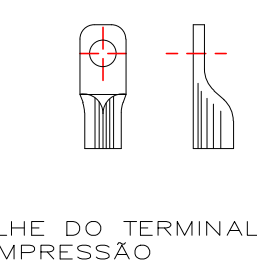
DETALHE DO TERMINAL A COMPRESSÃO
