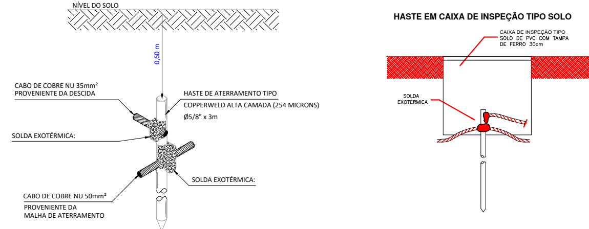
DETALHE DE CONEXÃO E SOLDA DA HASTE DE ATERRAMENTO
