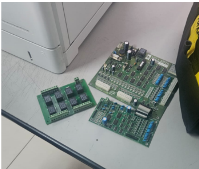
Foto 2 - Placa de relés com funcionamento comprometido.
