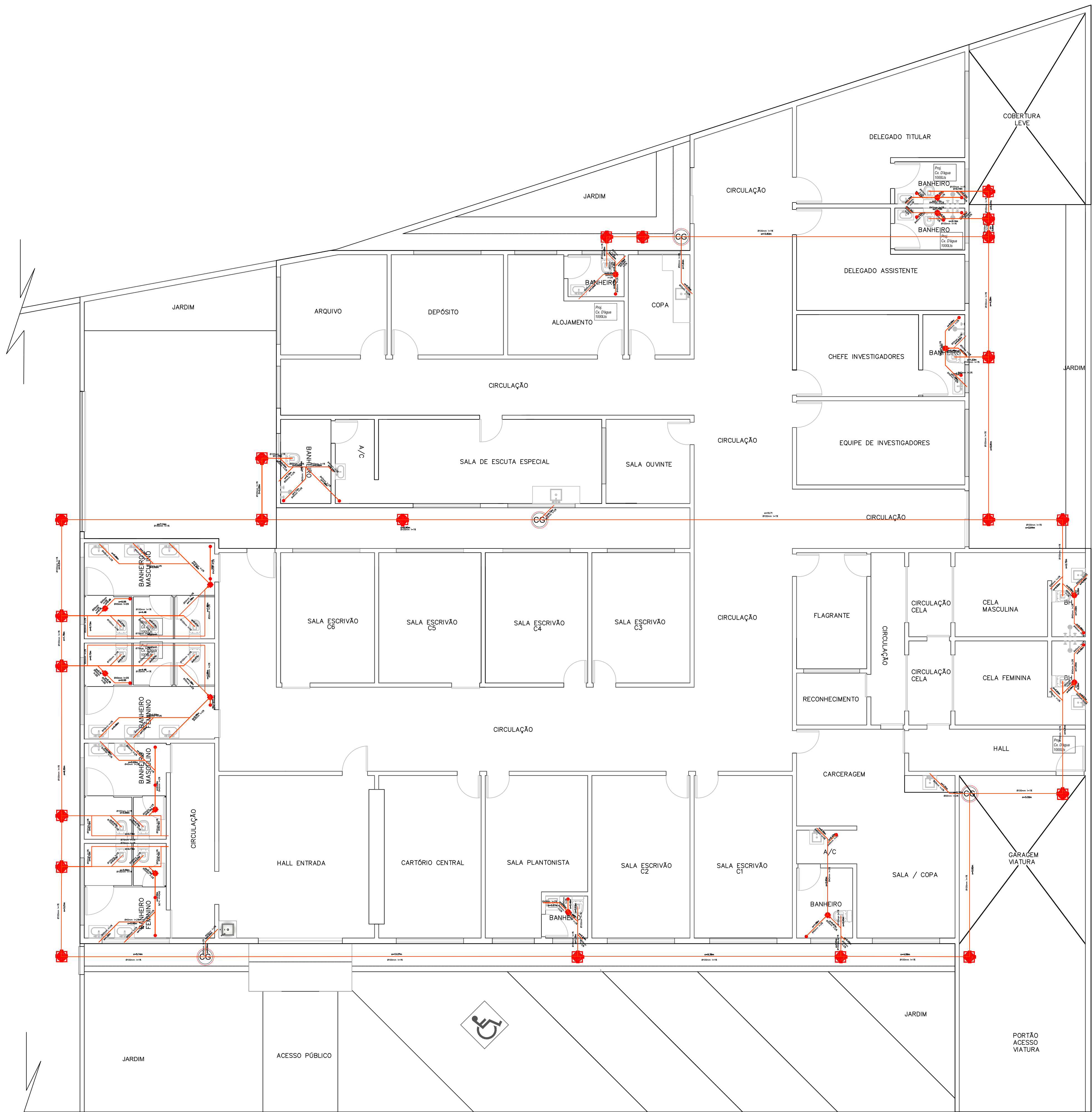
PLANTA BAIXA ESGOTO ESC. 1:75
