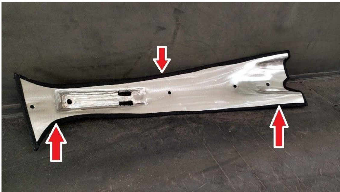
Figura 2 - Detalhe da aplicação da fita feltro nas bordas das chapas de aço
