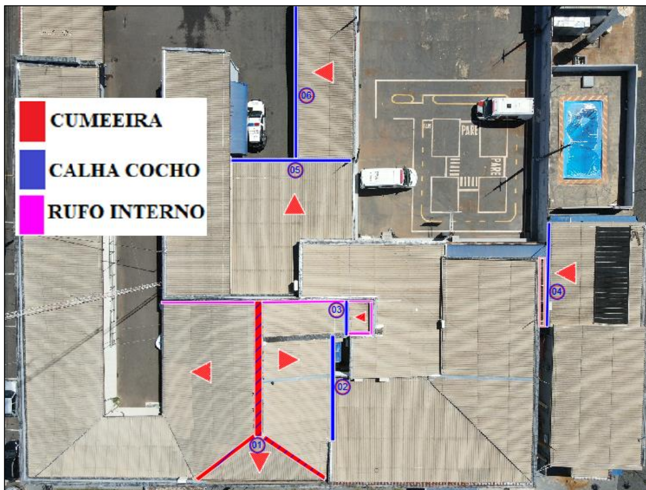
Figura 01: Imagem aérea de parte do telhado do 16º BPM/I, onde será substituído as calhas e rufos, devido a danos ocasionados por fortes chuva e ventos.
