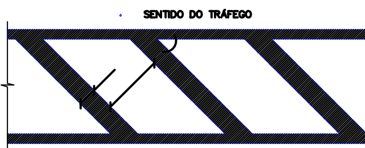
DETALHE DE CANALIZAÇÃO DE FLUXOS OPPOSTOS "ZEBRADA" Tinta: EXTRUDADO Cor: AMARELA
