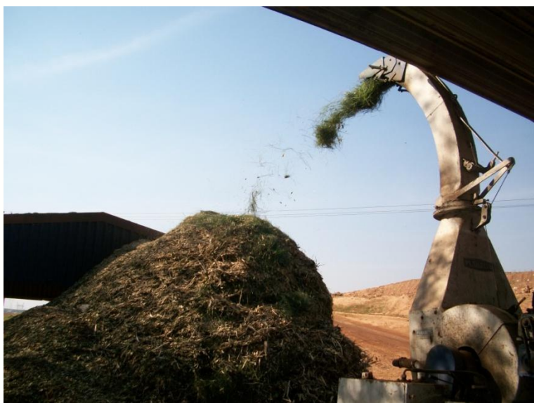
Figura 72 - Operação do Triturador de Galhos no Aterro Sanitário.
