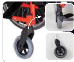
Rodas dianteiras 6"x40mm maciça e removíveis com sistema quick release, com garfo de nylon e ajuste de inclinação.
