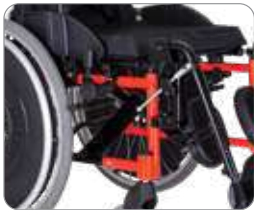
Estrutura em alumínio aeronáutico temperado. Pintura eletrostática.
