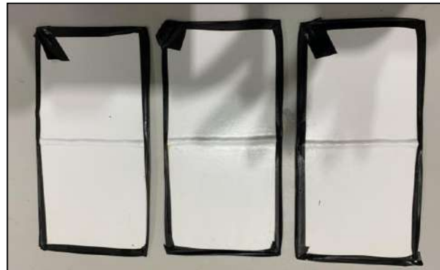
Foto 3 – Amostras após 1200 horas em exposição
