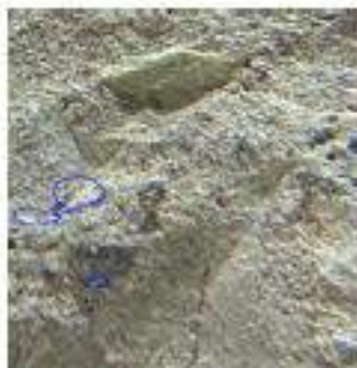
Figura 02 – amostra 01 Lamina cortada do corpo de prova Profundidade de 5,0 cm.
