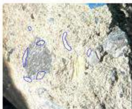
Foto 7: amostra 03 - pasta esbranquiçada na amostra e envolta do agregado, (imagem aumentada em 10X).
