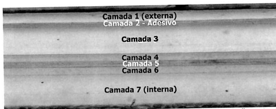
FIGURA 1. Imagem da seção transversal da amostra, após aplicação de solução contendo iodo.
