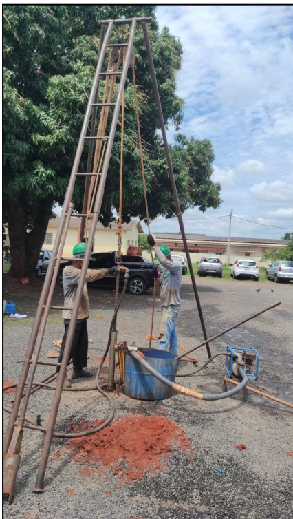
SP02 - Execução da sondagem SPT
