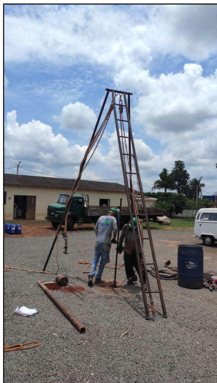
SP03 - Execução da sondagem SPT
