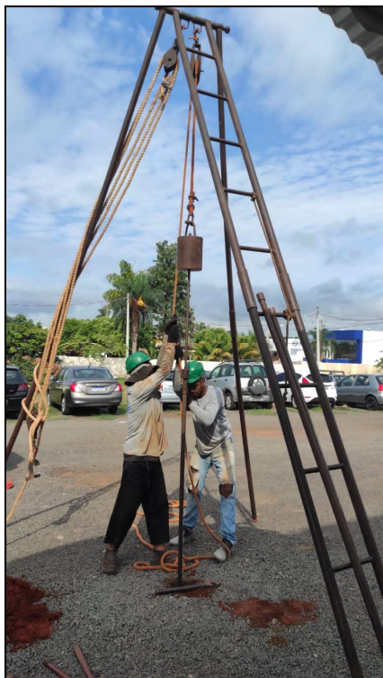
SP01 - Execução da sondagem SPT
