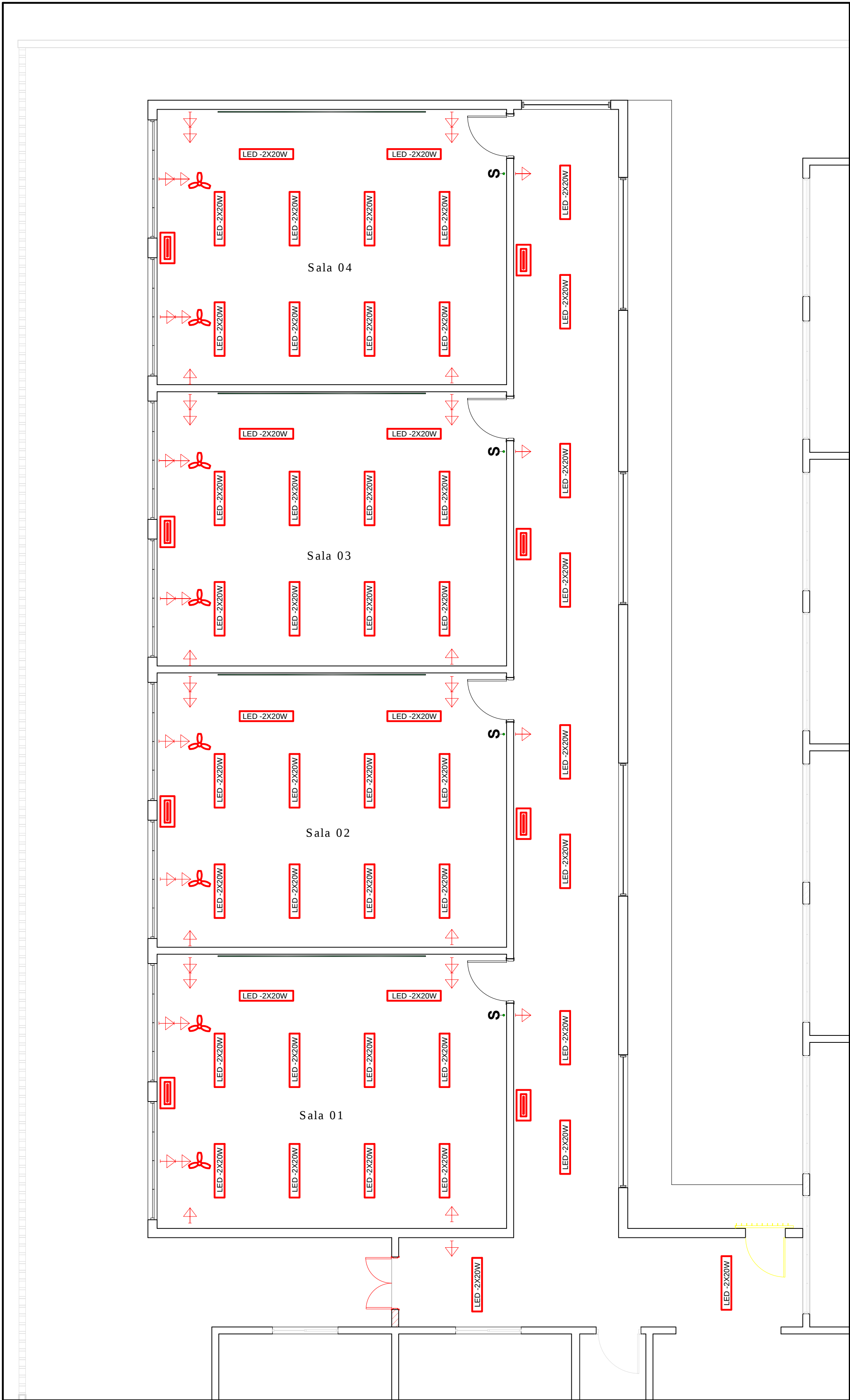
PONTOS DE TOMADAS E ILUMINAÇÃO Esc. 1:100
