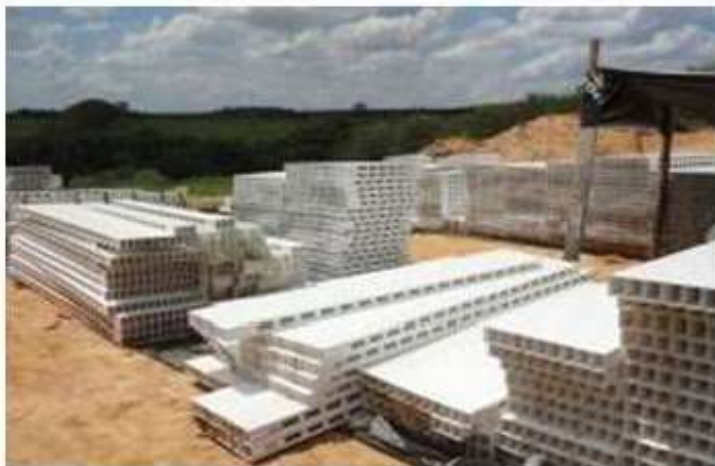
FIGURA 10 – Painéis de PVC pré-moldados na fábrica
