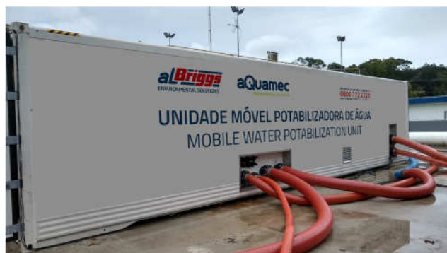
Unidade de Tratamento por Membranas de UF (Foto ilustrativa) – 180 m³/hora.
