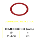
DETALHE "C" PLACAS DE REGULAMENTAÇÃO SEM ESCALA
