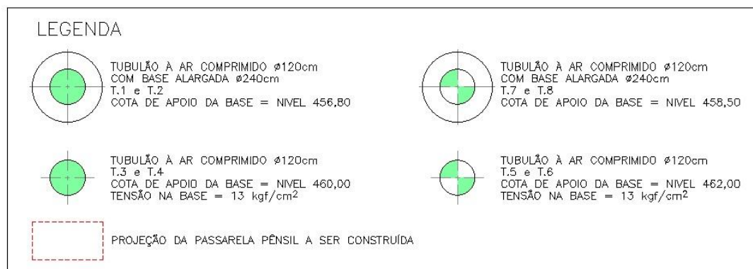
Imagens 03 e 04: Detalhes dos tubulões existentes. Tubulões T1, T2, T7 e T8 que deverão receber as provas de carga horizontal e tubulões T3, T4, T5 e T6 que deverão receber a prova de carga vertical.
