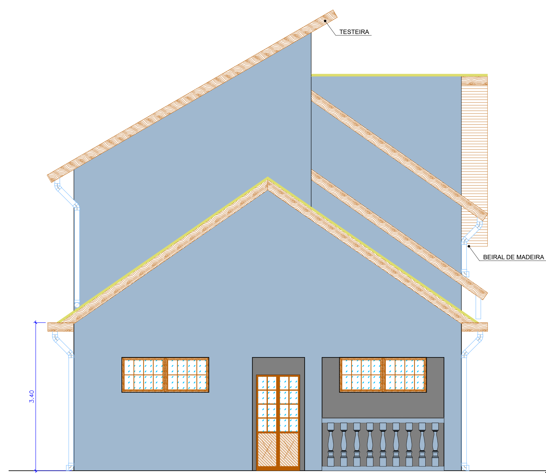
PLANTA DE ARQUITETURA: FACHADA TRASEIRA ESCALA 1:50
