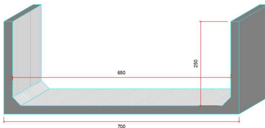
Canal Retangular Aberto de concreto armado com dimensões 6,5x2,5m - E90+3,18 a E105+18,18m.
