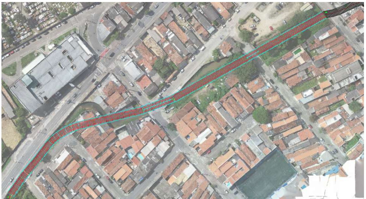
Figura 02 – Estaca E90+3,18 a E105+18,18 – canal retangular aberto com dimensões 6,5 m x 2,5 m
