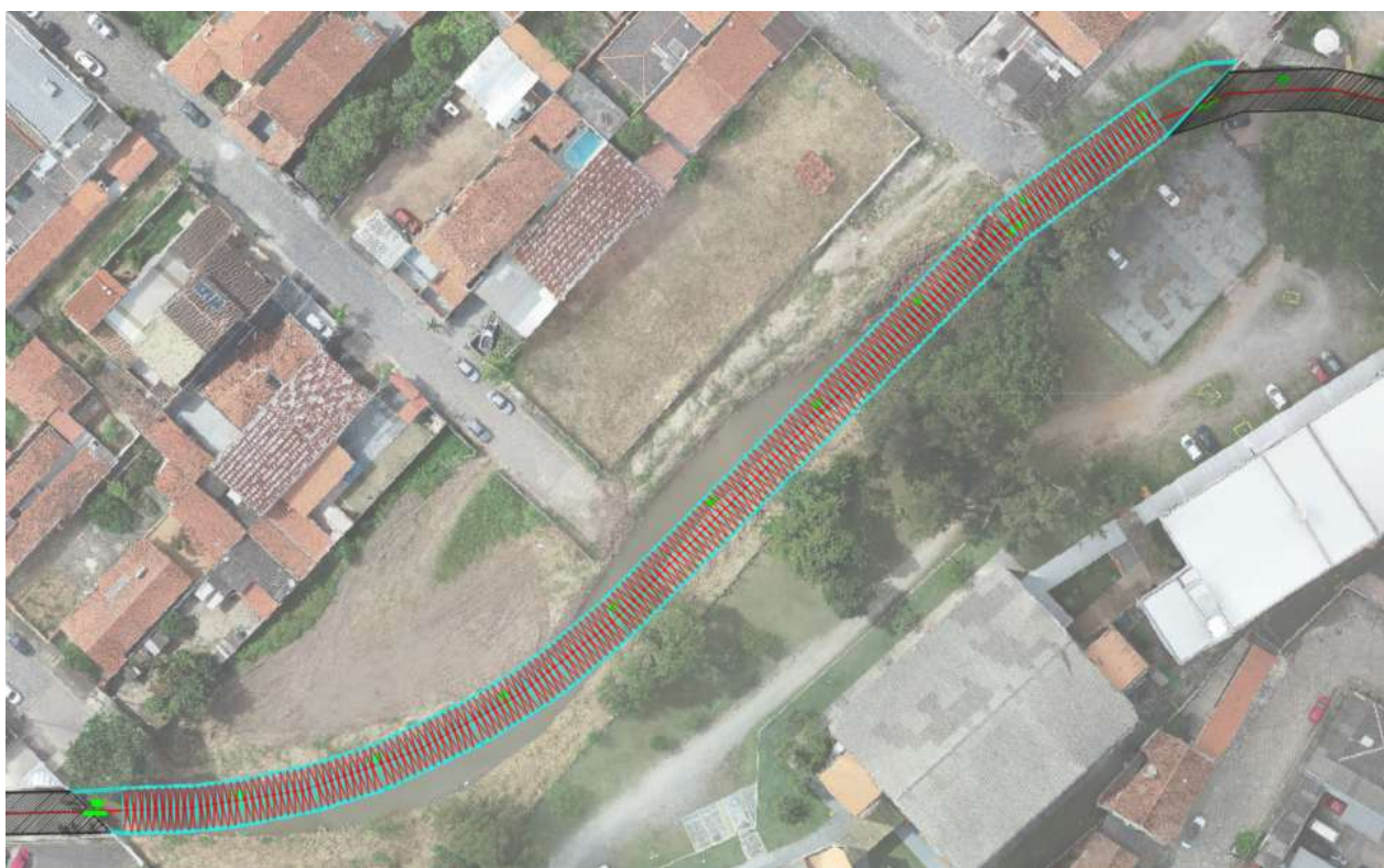
Figura 04 – Estaca E109+13,63 a E119+13,63 – canal retangular aberto com dimensões 6,5m x 2,5m
