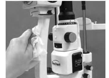
Figura MM-1 Limpeza da unidade principal
