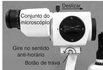
Figura SU-11 Instalação do microscópio
