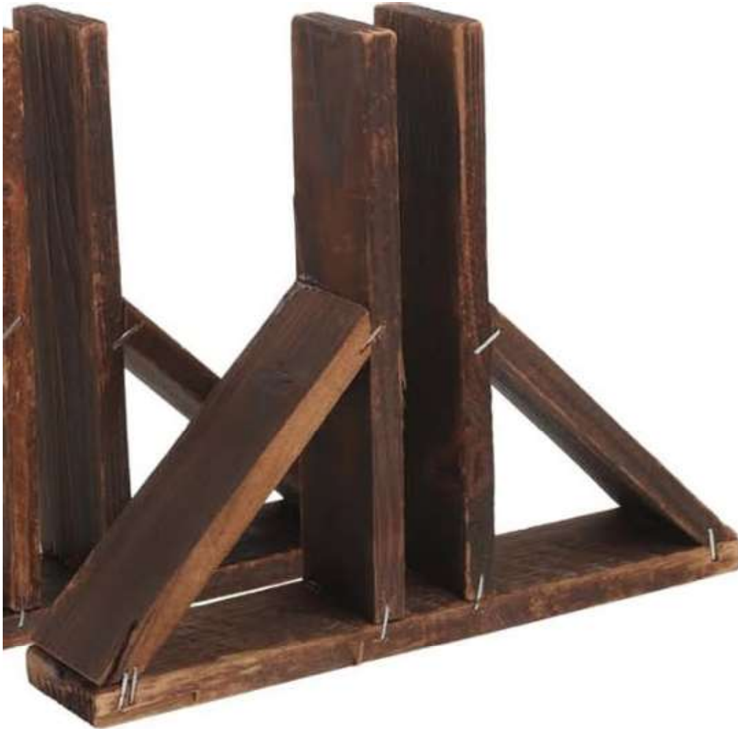
Modelo de estrutura triangular para o encaixe da placa do painel
