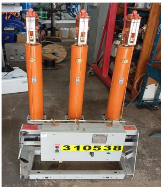
Disjuntor PVO a ser instalado na cabine
