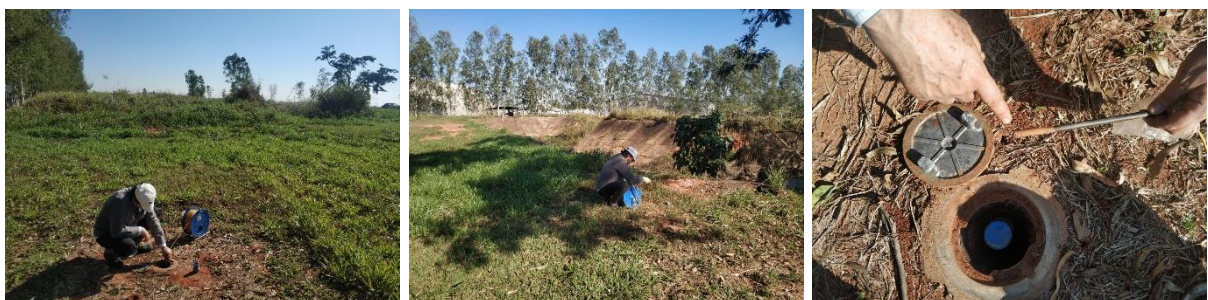
Fotos 13 a 15 – medição dos freáticos nos Poços de Monitoramento PM-01, PM-02 e PM03;
