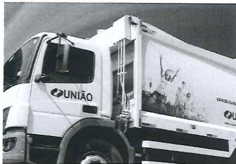
Caminhão compactador para coleta de lixo.
