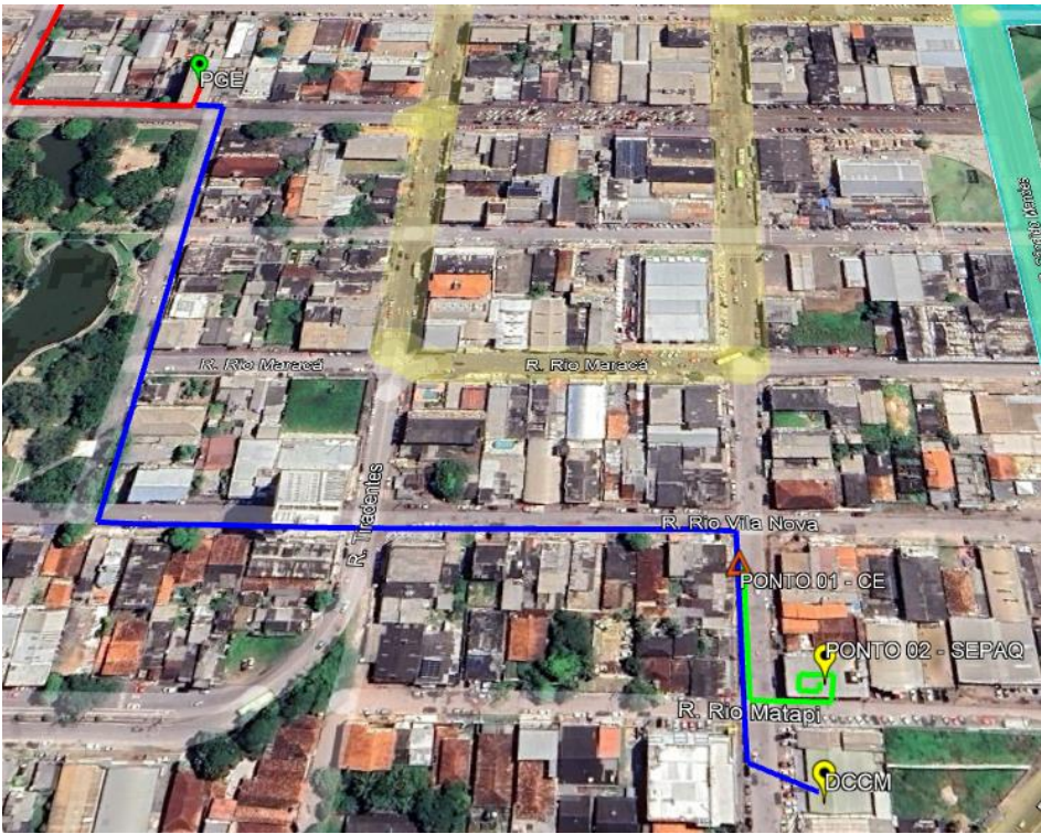
Figura 1 – Layout de lançamento de cabo óptico
