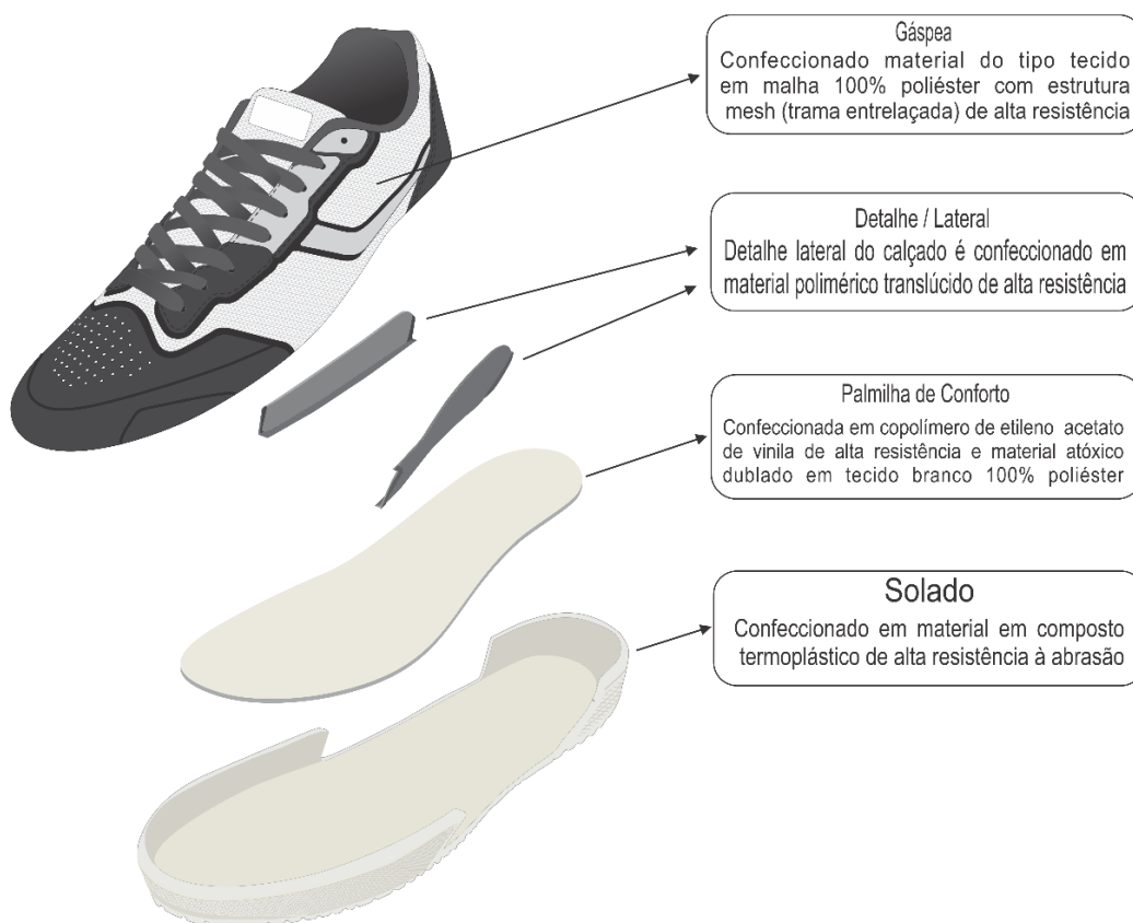
Figura 5 – Vista Perspectiva – Cabedal, detalhe lateral e solado
