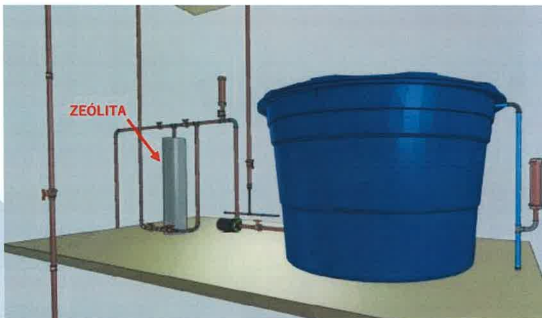
Imagem 3: Elemento Filtrante Clinoptilolita - Zeólita
