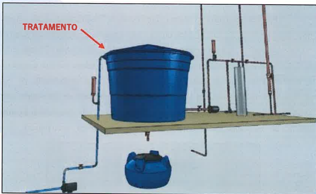
Imagem 2: Reservatório Inferior – Tratamento
