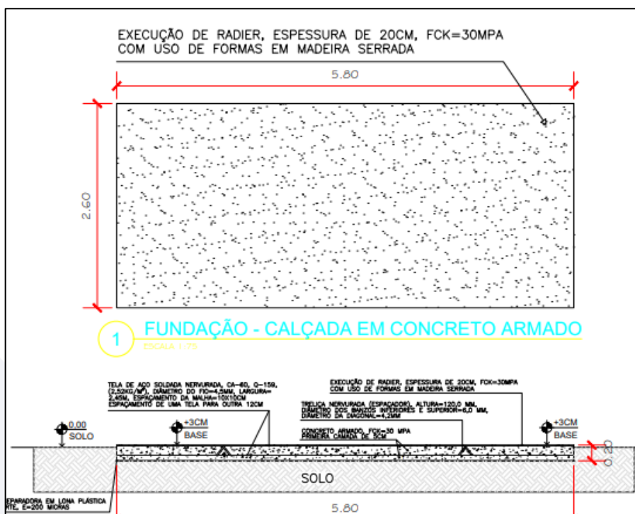
FIGURA 6 – ELEMENTO DE FUNFAÇÃO - RADIER
