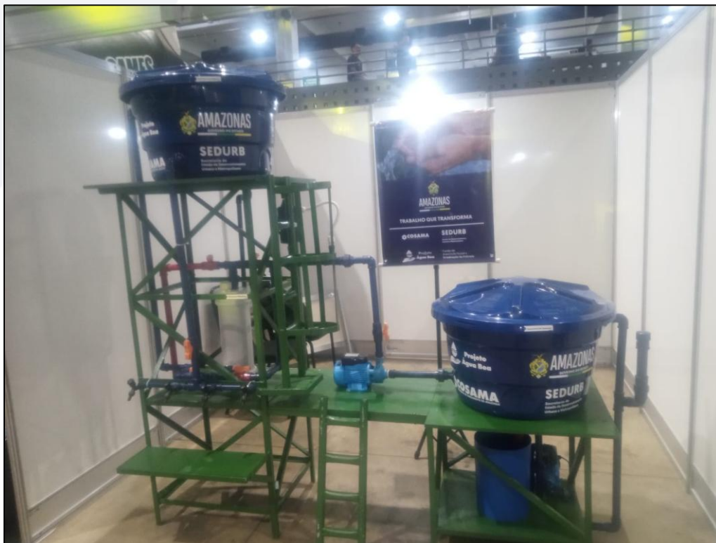
Imagem 10: Maquete do Sistema alternativo e coletivo simplificado de tratamento de água – Água Boa
