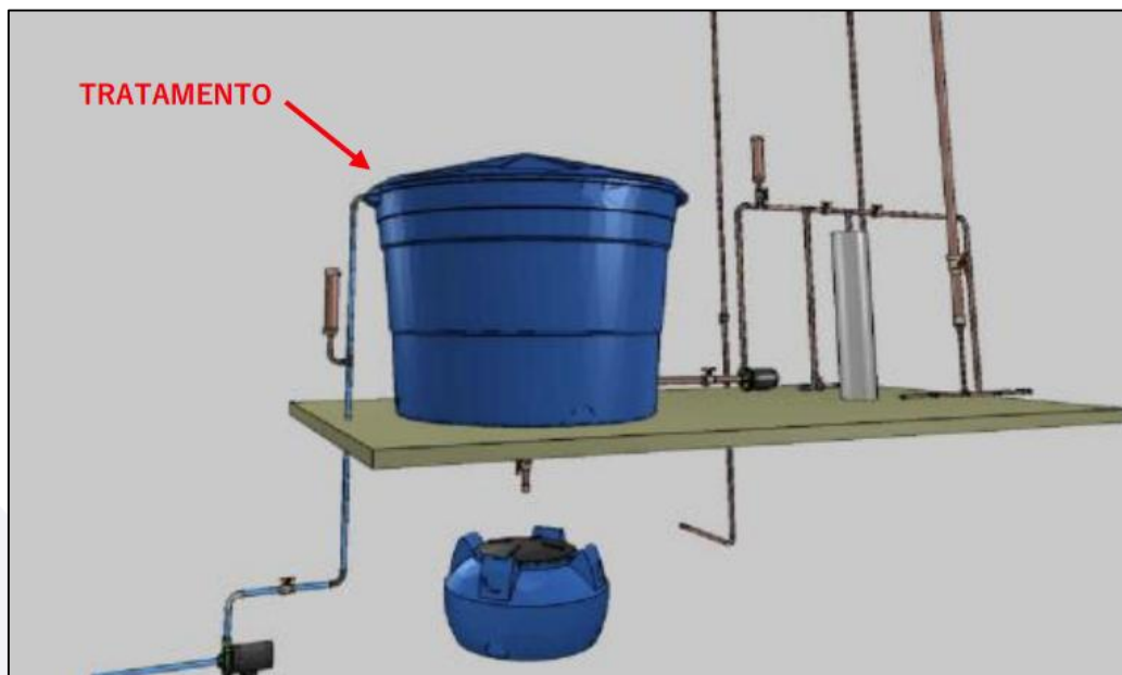
Imagem 3: Reservatório Inferior – Tratamento
