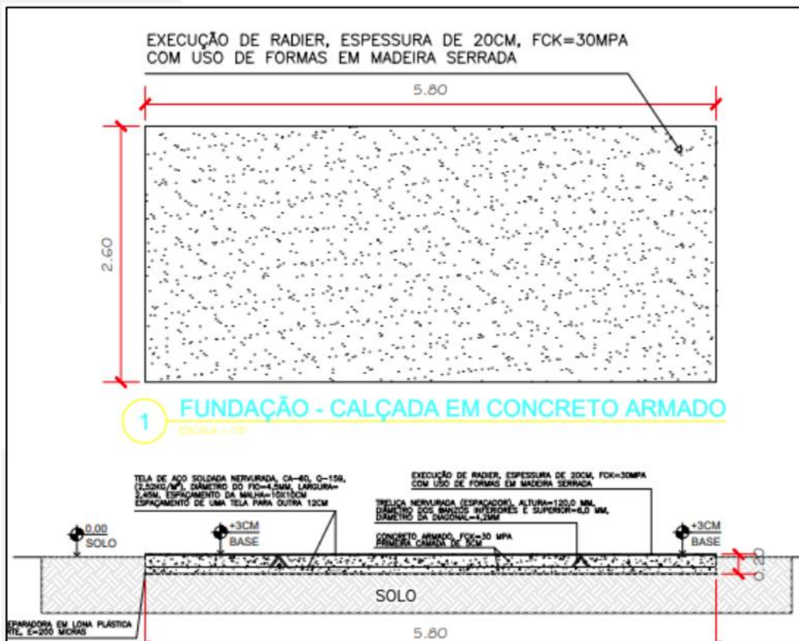
Imagem 7: Elemento de Fundação - Radier
