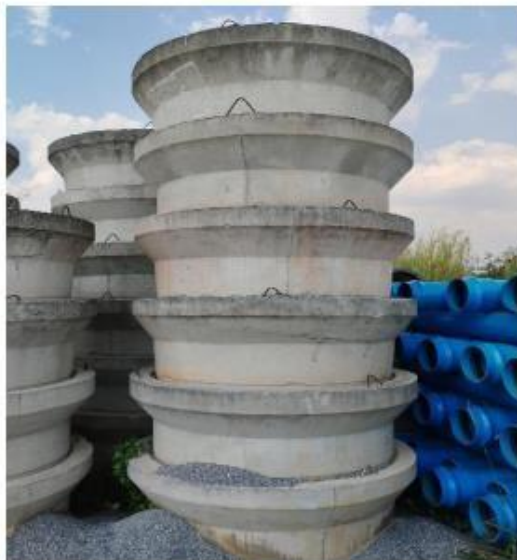
Figura 1 Modelo de encaixe tipo Ponta/Bolsa
