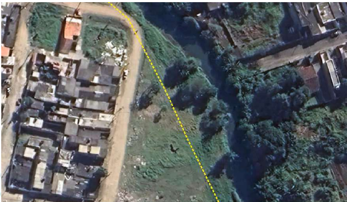
Figura 5. Coletor desviando de exemplares arbóreos isolados.
