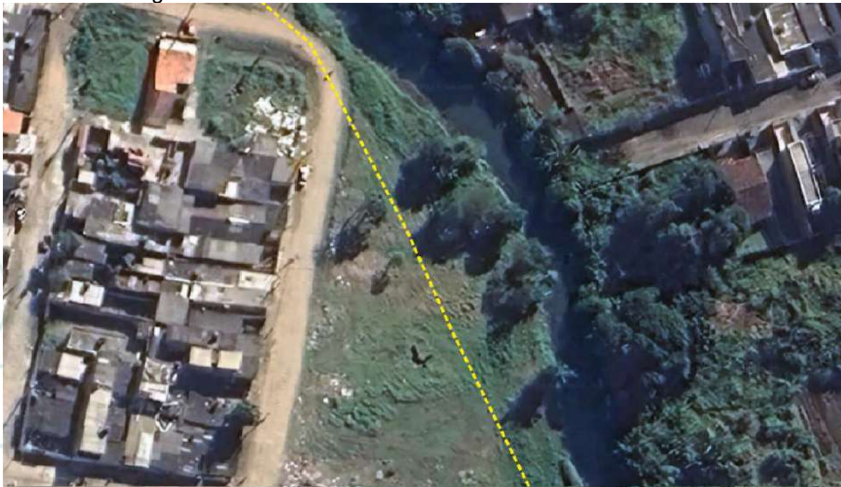
Figura 9 - Detalhes do caminhamento evitando árvores isoladas
