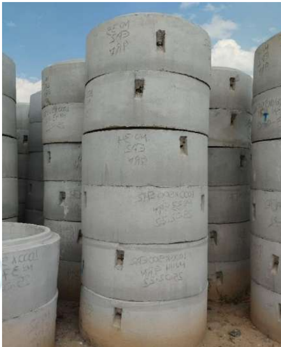
Modelo de Encaixe tipo MACHO/FÊMEA (anel de concreto/Aduela de concreto)
