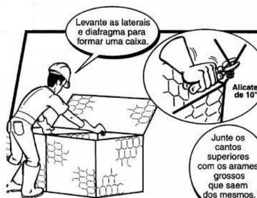
Figura 3.2 Posicionamento dos painéis laterais e diafragmas.
