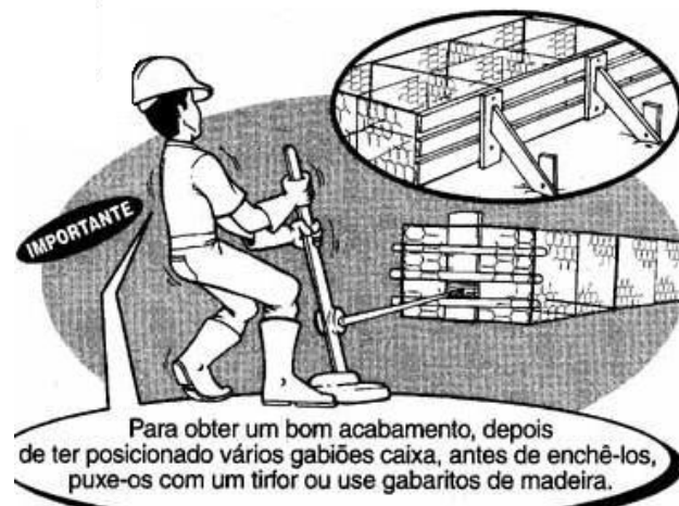
Figura 3.5 – Detalhe da utilização do tirlor ou gabarito.
