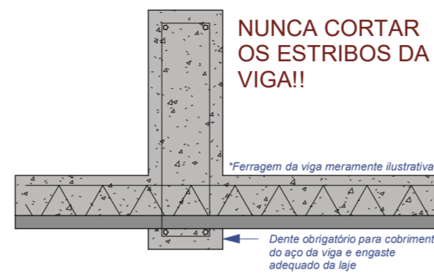
FIXAÇÃO LAJE/VIGA INVERTIDA ESCALA 1 : 20
