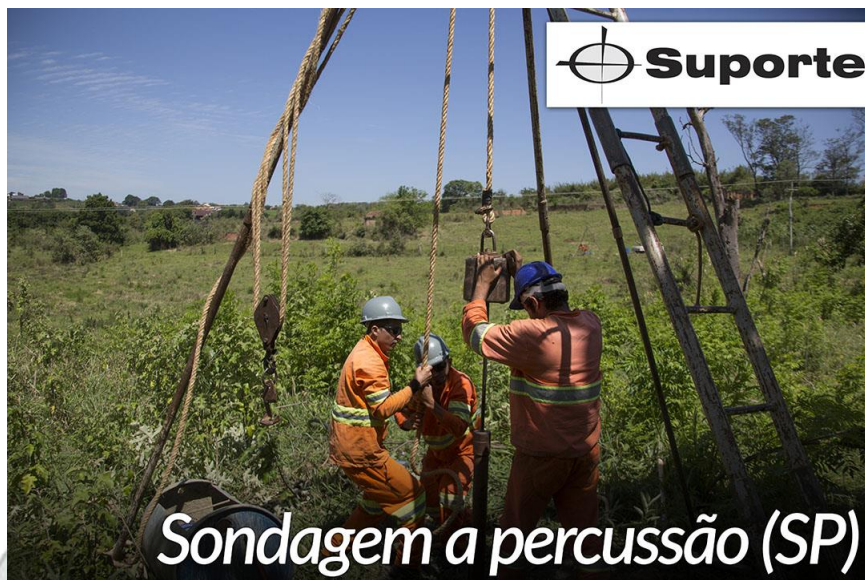
Imagem 02 - Sondagem a percussão - execução do ensaio
